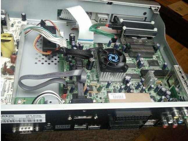
Moduł phoenixa podpięty do złącza USB wewnątrz tunera.
